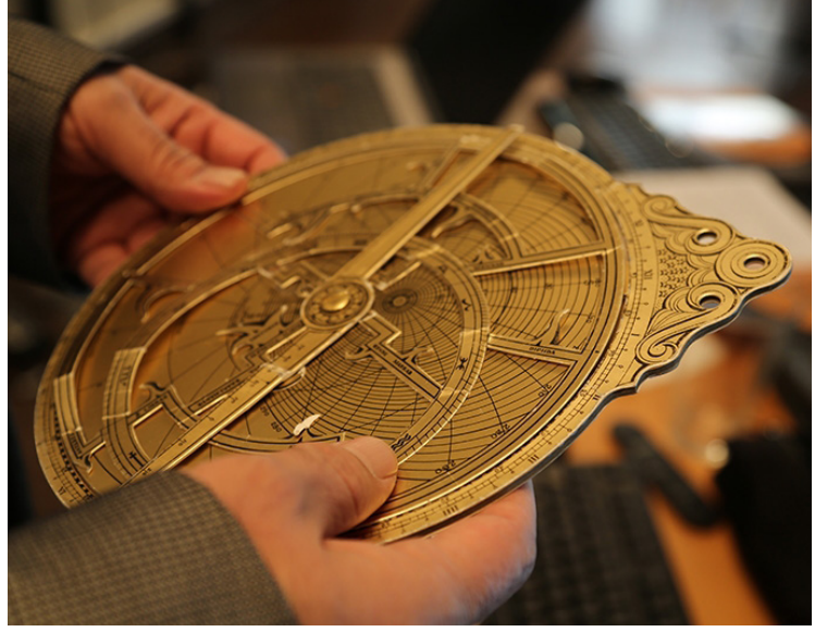
Görsel 5.22 Usturlaplarda stereografik iz düşümü yöntemi tercih edilmiştir.
